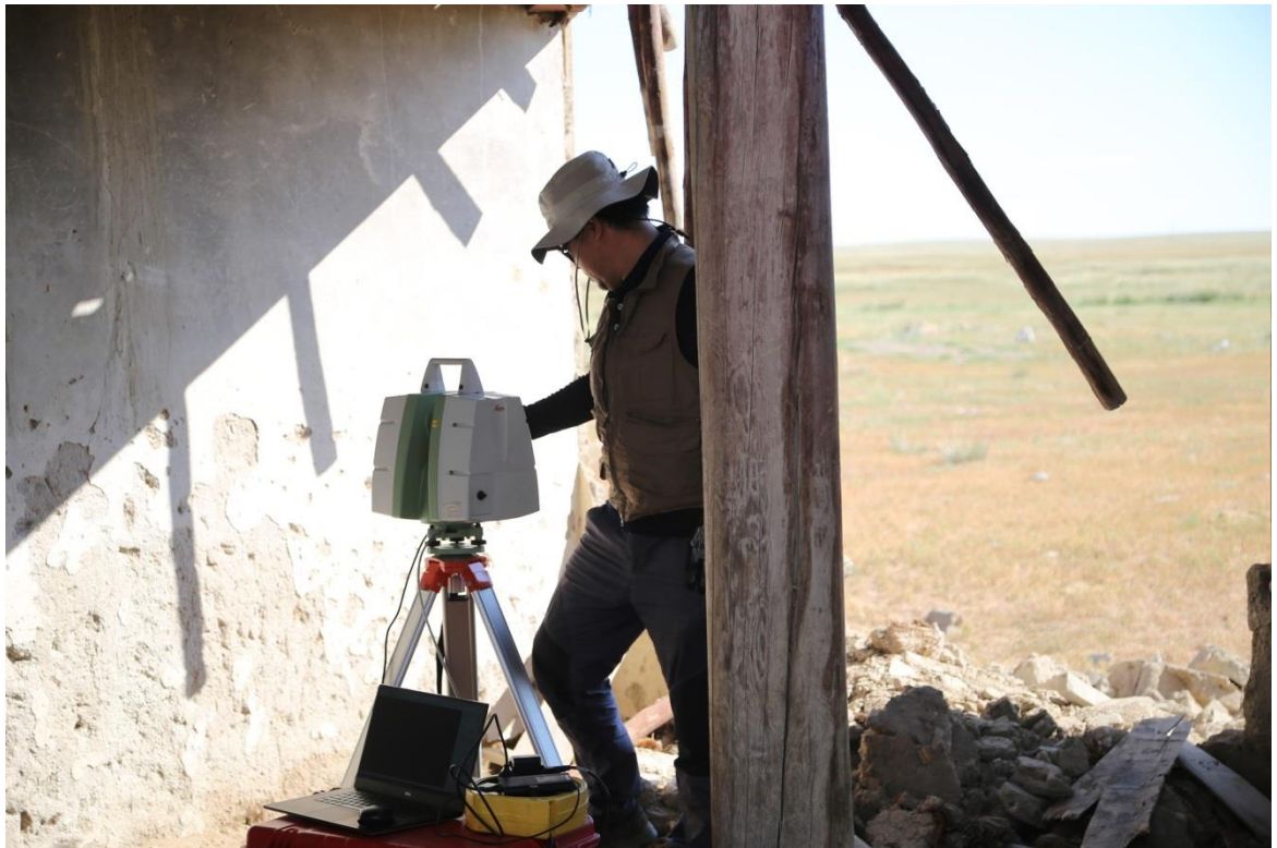
Дуганы дотор талыг 3D скан хийж байгаа нь
